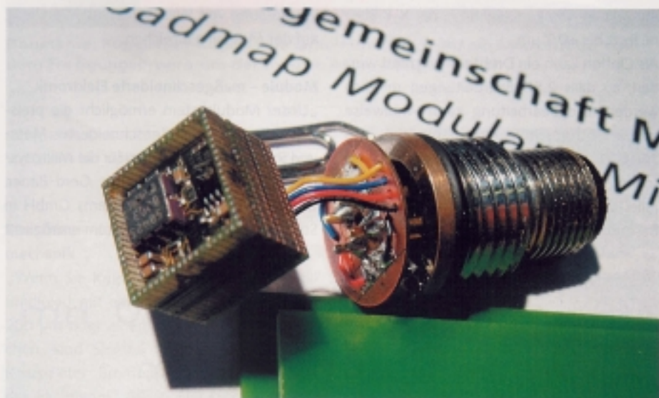
Beim Match-X-System ermöglichen vertikal anreihbare Module mit einem genormten Bus maßgeschneiderte „Prozess-Intelligenz“ direkt am Sensor (Fotos: Klaus Vollrath)
