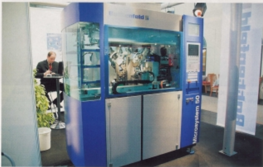
„Mikrotauglich“: Für die Microsystem 50 von Battenfeld gibt es ein breites Angebot an Sonderausrüstungen vom Reinraummodul über Entnahme- und Prüftechnik bis zur Ablage in Blisterbändern oder Trays
