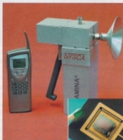
Nach ist sie größer als ein Handy – die elektronische Nase Kamina, die mit 38 Sensoren unterschiedlichste Gase identifizieren kann. Die Auswerteelektronik nimmt fast den ganzen Raum ein. Der Chip ist der Clou: Die obenauf beschichtete Gradientenmembran verändert ihre Dicke von Segment zu Segment um wenige nm/mm und lässt dadurch unterschiedliche Gasmoleküle passieren (Bilder: FZKa)
