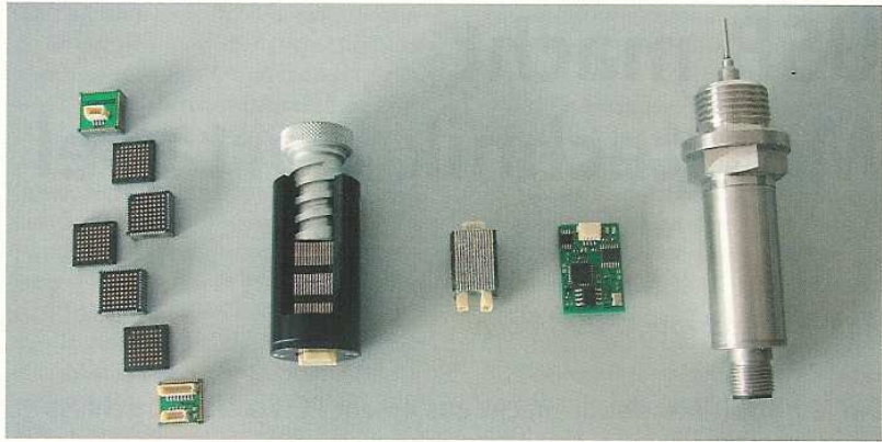
Bild 5. Entwicklungsphasen von links nach rechts: einzelne Match-X-Bausteine, lösbare Stapel mit Federmatrix, Match-X-Stapel verlötet, auf Leiterplatte überführtes System, komplettes Temperatursystem mit eingebautem Match-X-Stapel
