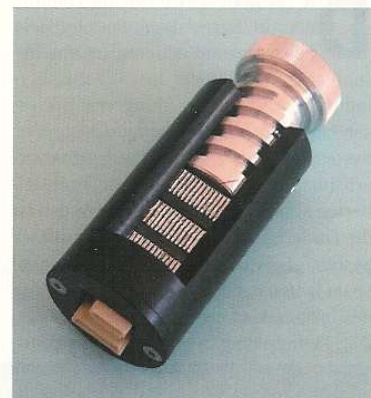
Bild 3. In der ersten Phase des Aufbaus werden die Komponenten vorläufig über eine Federmatrix miteinander verbunden
